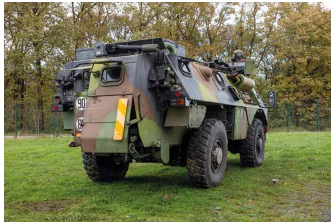
Ci-contre. Le VAB de reconnaissance NBC, en service au sein du régiment, est conçu pour identifier et caractériser la menace liée aux toxiques de guerre ou à la radioactivité. Il dispose notamment d'un spectromètre de masse qui permet l'analyse des produits toxiques prélevés.
